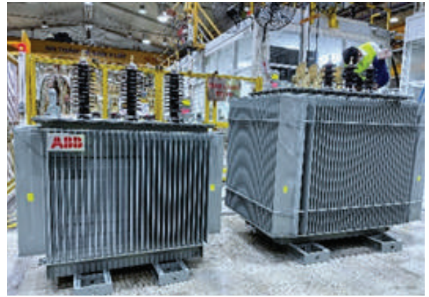
Chứng kiến kiểm tra nghiệm thu máy biến áp Hitachi tại nhà máy The Factory Acceptance Test Witnesses (FAT) of Hitachi Transformers
